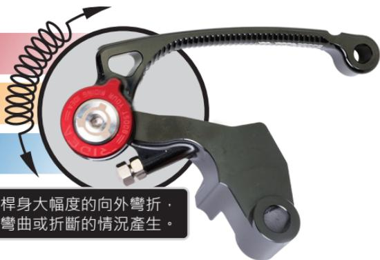
拉桿的樞軸關節能允許桿身大幅度的向外彎折，在越野操駕時防止拉桿彎曲或折斷的情況產生。
